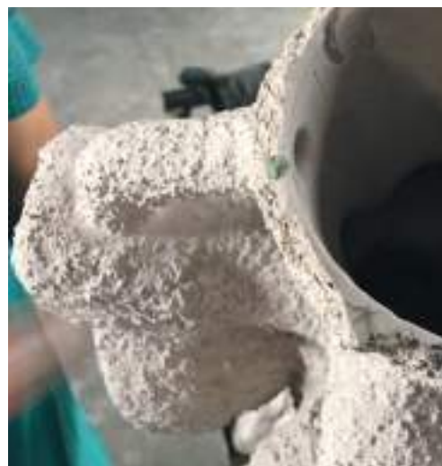
07 Evacuazione delle cere Dewaxing
