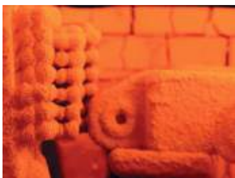
08 Preriscaldamento grappolo Preheating
