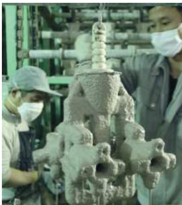
05 Rivestimento ceramico ad immersione Ceramic coating
