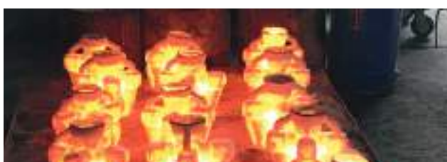
10 Raffreddamento fusioni Cast cooling
