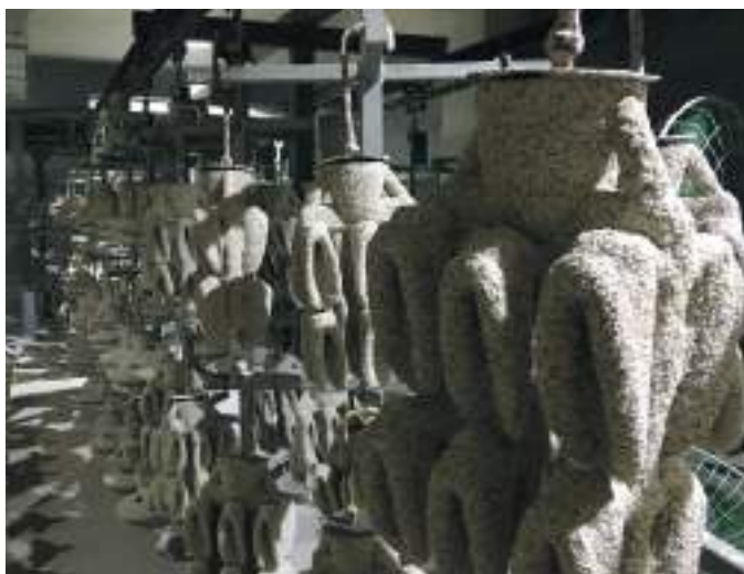
06 Essicazione conchiglie Shell drying
