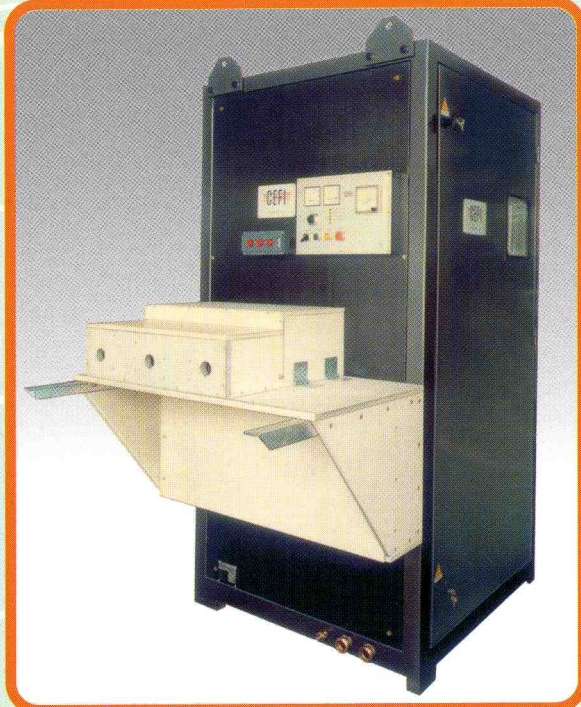
Forno 150 KW - 8 KHZ con tre punti di riscaldamento in sequenza, per il riscaldamento di utensili presagomati.
