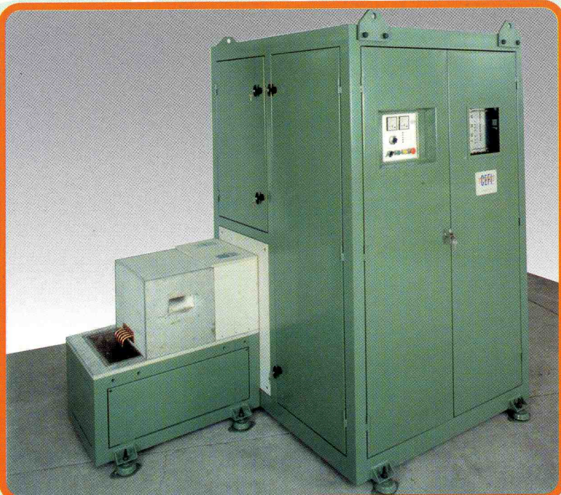
Forno 250 KW - 1 KHZ che alimenta una macchina riscaltrice/piegatrice per la formatura delle forche dei carrelli elevatori.
