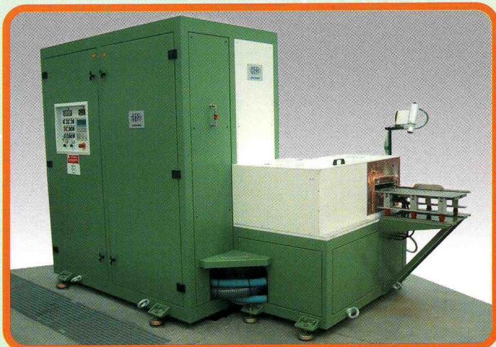
Forno 300 KW - 2,4 KHZ con carico manuale dei pezzi in bobina ad estrazione automatica mediante espulsore. 300 KW - 2.4 KHZ heater with manual loading of the parts into the coil and automatic extraction by ejector.
