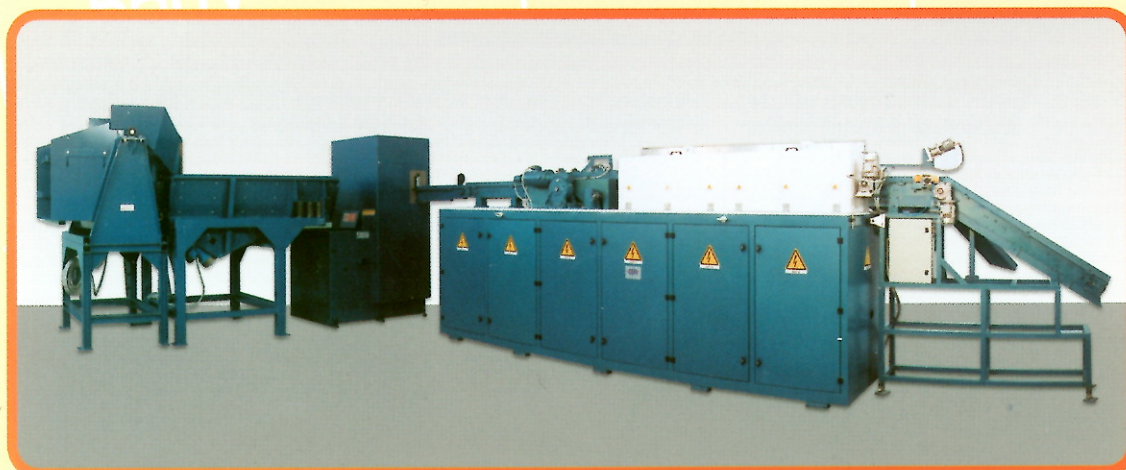
FC21 - 1000 kW - 1 kHz con ribaltacassoni, tavola vibrante, caricatore automatico multilame e sistema di accettazione/scarto degli spezzoni
