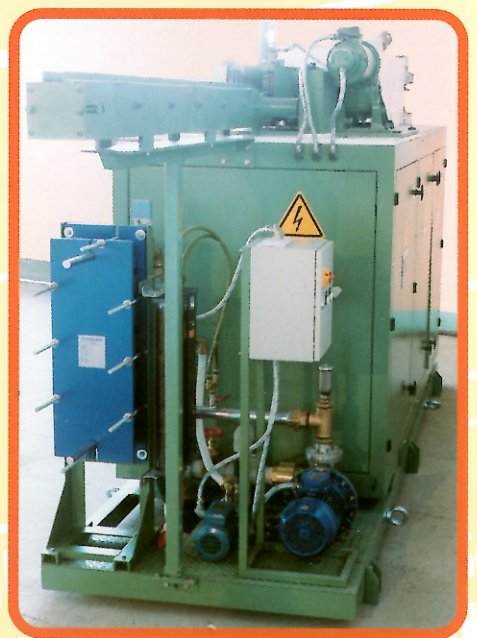
Circuito chiuso completo di raffreddamento del forno con acqua demineralizzata Closed loop cooling circuit of the heater with deionised water
