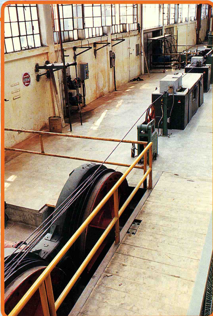
FORNO FCF9 - 300 kW - 6 kHz, per il trattamento di 4,5 ton/ora (96 m/min) di treforo 1/2". Versione fissa.
