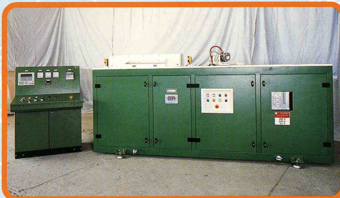
FORNO FCF6 - 150 kW - 6 kHz, idoneo per trattare 1,5 ton/ora (150 m/min) di treccia 3 x 3. Versione fissa.
