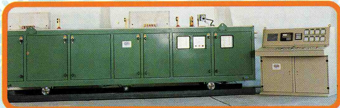
FORNO FCF15 - 600 kW - 6 kHz, produzione massima 8,4 ton/ora (120 m/min) con trefolo 6/10". Versione mobile.
